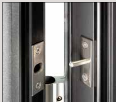
2 Bolzensicherungen im oberen und unteren Bereich verhindern das Aushebeln des Türflügels (Einbruchschutz)
